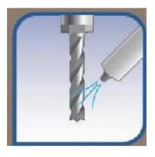
Устройство обеспечивает подачу воздуха на инструмент в зону резания.
