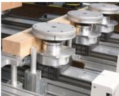
Балки суппорта из экструдированного алюминия, имеют широкую базу опоры и скользят вдоль оси X по закалённым направляющим круглого сечения, имеют жёсткую и надёжную пневматическую фиксацию при помощи двух тормозов пневматического действия (один со стороны передней направляющей скольжения, второй - с задней).
