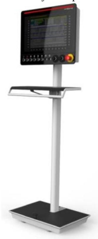
Цветной светодиодный сенсорный дисплей диагональю 21,5" формата 16/9 позволяет управлять основными функциями станка в максимально быстрой и эффективной манере благодаря следующему:
