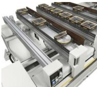
"Свободные" присоски, то есть развязанные механически с рабочим столом, каждая присоска жёстко закреплена на суппорте при помощи двух безопасных способов фиксации: механического при помощи нижнего профиля, который зацепляется на поверхности рабочего стола, и пневматического при помощи подвижного бокового профиля, который скользит вдоль всего рабочего стола и раскрывается наружу, жёстко фиксируя базу присоски.
