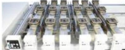
Способность свободно конфигурировать присоски, как в отношении их положения вдоль суппорта, так и их количества на каждом суппорте, обеспечивает оператору возможность **всегда находить наилучшую из возможных конфигураций для каждой программы обработки.**
